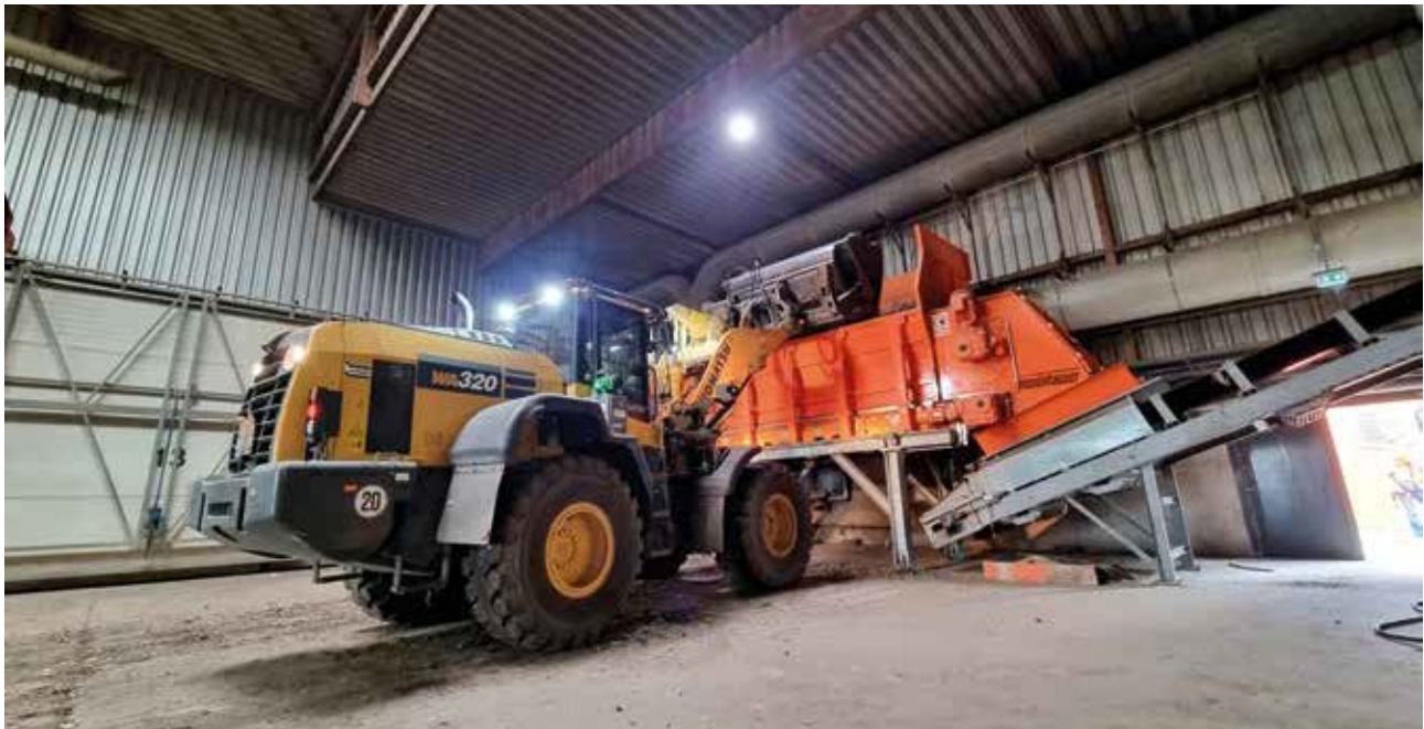
Aufgabedosierer für die Umsetzung der Feinfraktion in der Rottehalle der MBA
