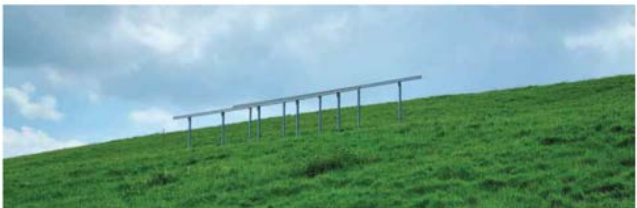
Testfeld zur Prüfung der PV-Tauglichkeit auf dem Deponiehügel in Großefehn
