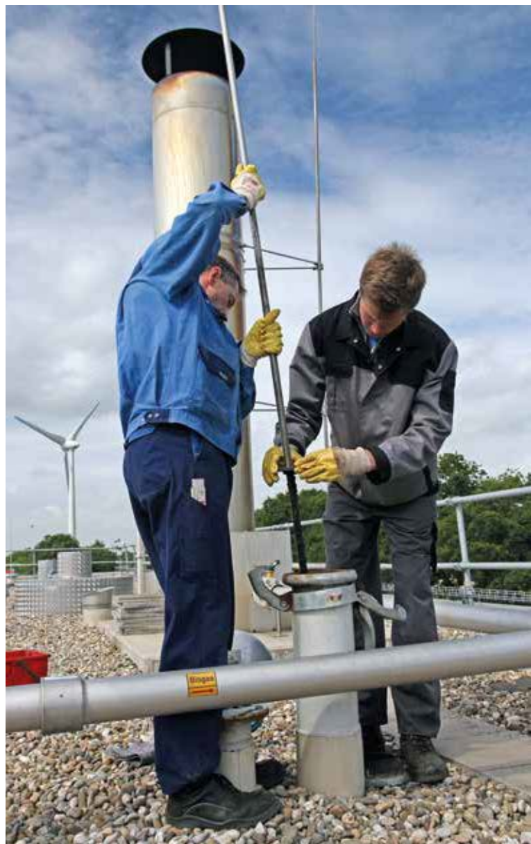
Probenentnahme am Fermenter der Vergärungsanlage
