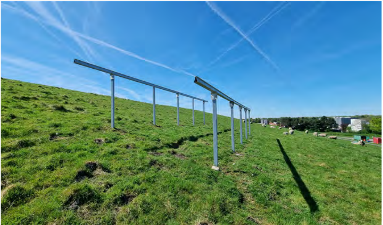
Testfeld zur Prüfung der PV-Tauglichkeit auf dem Deponiehügel in Großefehn
